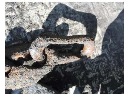
刮板机链条腐蚀磨损
