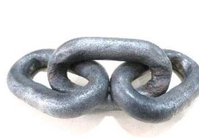
捞渣机链条腐蚀磨损
