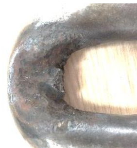
捞渣机链条腐蚀磨损
