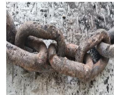
刮板机链条腐蚀磨损
