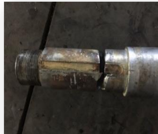
轴在键槽处断裂
