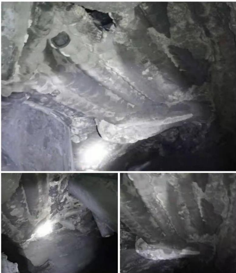
A气化炉：于2019年5月17日开始运行，运行200天后，于2019年12月3日气化炉分别出现渣口压差升至0.08MPa，最高到0.1MPa、气化炉液位上涨至100%，同时渣样无拉丝现象、颗粒均匀，气体成分甲烷及二氧化碳值在正常范围，气化炉温度1280℃，综合数据分析判断是气化炉激冷室破泡条结垢堵塞造成的。
