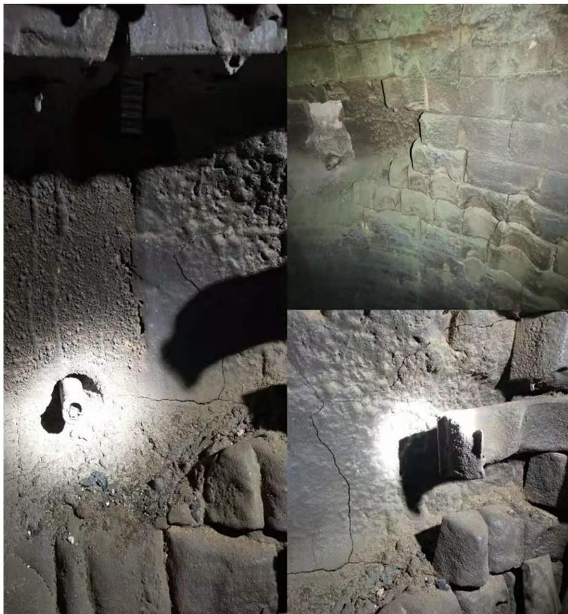
A气化炉：于2020年4月21日开始运行，运行172天后，于2020年10月9日中控人员发现上膨胀缝处TY13087A7炉壁温度开始上涨，通知现场人员现场测温确认，测温枪测得在04热偶附近最高温度425℃，到当天18:38分中控TY13087A7炉壁温度涨到336℃，壁温已经超出运行指标，气化炉已经无法继续运行，于19:54分A气化炉被迫停车。检修期间检查炉砖发现上膨胀缝04热偶附近三层炉砖已完全脱落，上膨胀缝筒体炉砖已使用1.6万小时。
